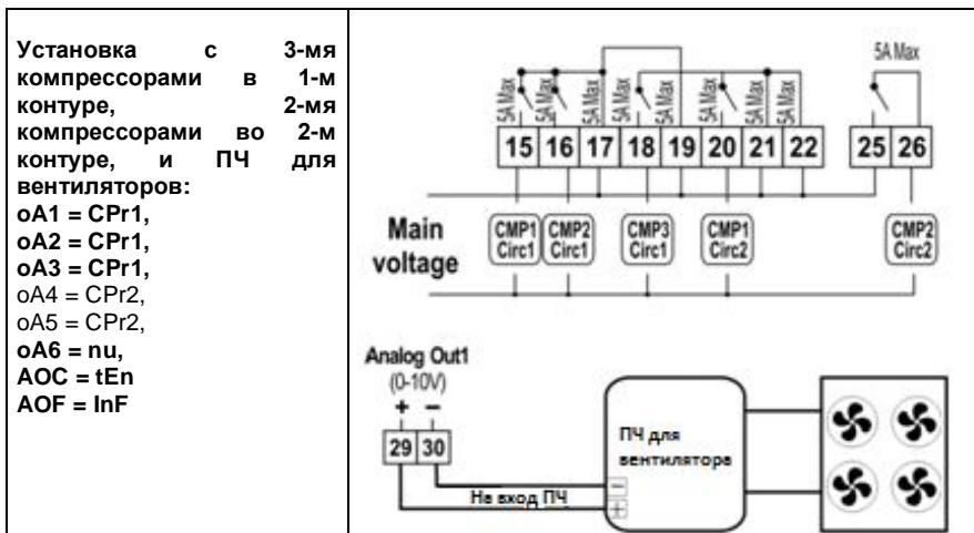
**CtyP Тип компрессора:** указывает тип компрессора для корректного алгоритма управления.
