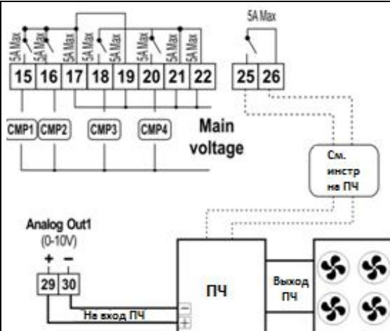
**Установка с 1-м компрессором с ПЧ + 2 стандартных компрессора и 2 вентилятора:**
