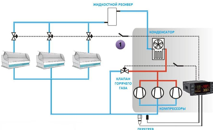
Для включения этой функции настройте реле параметром **oA2 / oA3 / oA4 / oA5 / oA6**, как защита от залива, например, **oA4 = Liq**, после чего включите его в цепь блокирования подачи жидкости.
