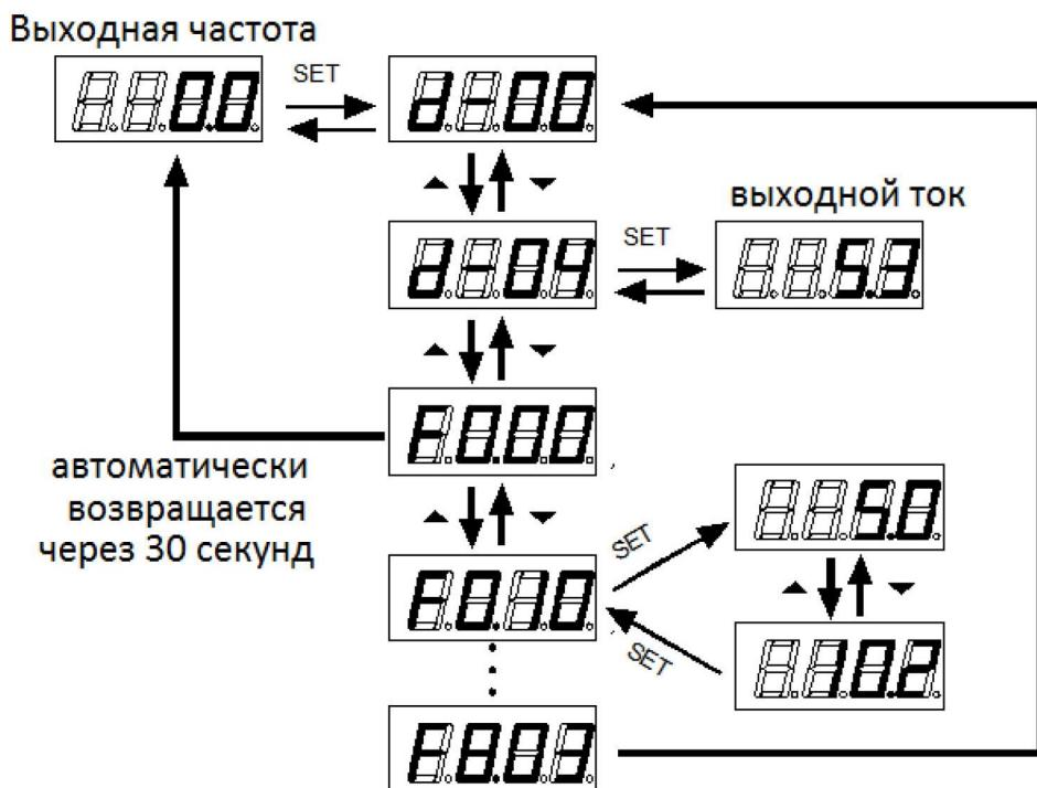
После установки параметра возвращаемся в мониторинг частоты:
