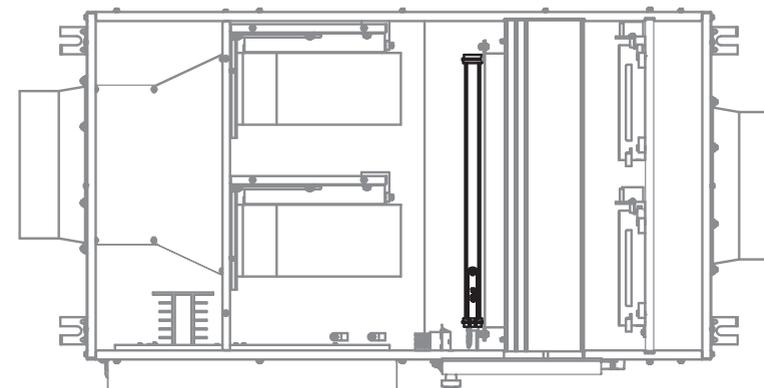
4. Зафиксируйте положение электрического нагревателя с помощью 4 винтов по углам, убедившись в том, что зона электрического подключения находится со стороны боковой дверцы.
