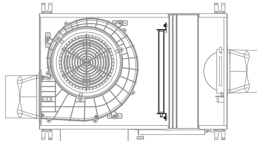
4. Зафиксируйте положение электрического нагревателя с помощью 4 винтов по углам, убедившись в том, что зона электрического подключения находится со стороны боковой дверцы.
