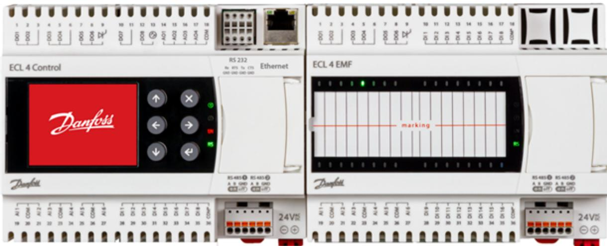
ECL4 Control 368 Plus обеспечивают регулировку температуры теплоносителя, поступающего в систему отопления, в зависимости от температуры наружного воздуха в соответствии с температурным графиком в целях обеспечения заданной температуры воздуха в отапливаемых помещениях здания, а также поддерживать требуемую температуру горячей воды в системе ГВС.
