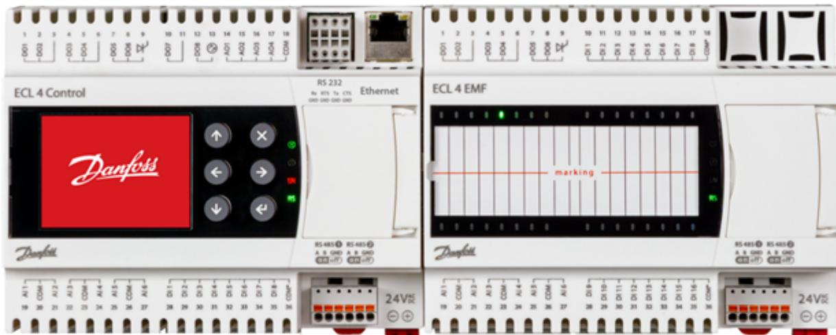
ECL4 Control 361 Plus Ethernet обеспечивают регулировку температуры теплоносителя, поступающего в систему отопления, в зависимости от температуры наружного воздуха в соответствии с температурным графиком в целях обеспечения заданной температуры воздуха в отапливаемых помещениях здания.
